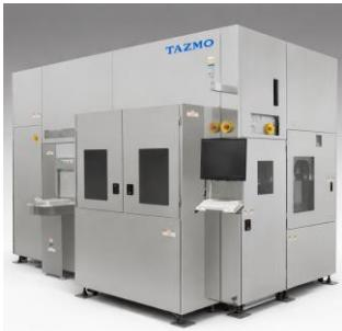
高性能チップの製造に欠かせないウェーハの薄化を実現する仮接合・剥離装置の開発・設計・製造・販売を行っています。ウェーハにガラス支持体を貼り合わせることで、ウェーハの損傷を防ぎながら薄化が可能です。
