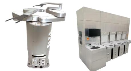
半導体製造装置内で使用される搬送口ボットや、ユニットをフレームに組み込んだEFEMなどの開発・設計・製造・販売を行っています。
